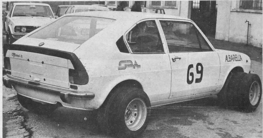
Le tre Alfisud TI preparate dall'Autodelta per il Rally dalla Costa d'Avorio alla Costa Azzurra avranno la possibilità di «moltiplicare» le ruote su un medesimo asse per mezzo di speciali colonnette di fissaggio prolungate. L'ideale per aumentare l'aderenza e togliersi d'impaccio
