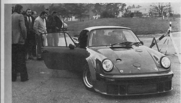
Due immagini della nuova Porsche gr. 4. Nella parte anteriore, ai lati del radiatore olio, i due piccoli radiatori acqua dello scambiatore di calore per l'aria di sovralimentazione. I cerchi da 15" sono i BBS smontabili
